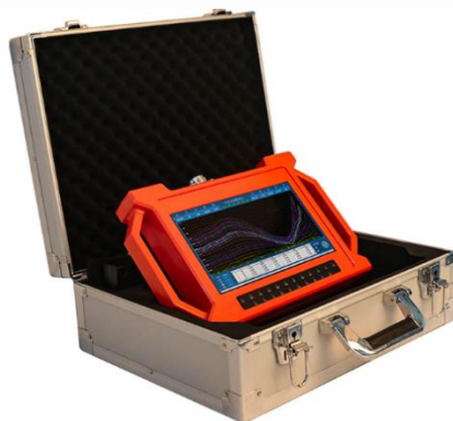
Figura 9. Detector geofísic d'autoanàlisi de la sèrie PQWT-GT (Font: pqwtdetector)
