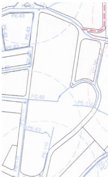
Imatge 2: Segons el planejament de l'any 2012 en el camp de futbol hi ha una canonada de fibrociment de 50mm, per tant caldrà fer una nova escomesa fins a la xarxa general on hi hagi una canonada de 110 mm.
