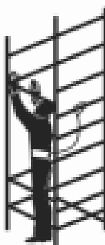
USAR CINTURÓN EN MONTAJE Y DESMONTAJE
