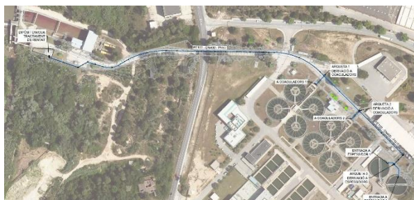
Il·lustració 6: Impulsió de captació cap a la zona de decantadors/espessidors
