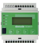
SCMI-01.5 Control de temperatura autónomo para refrigeración y calefacción (como unidad subordinada), Temperatura de evaporación de hasta -10 °C, Control por temperatura o Presión Señal (0-10 V) para evaporadores comerciales con motor EC
