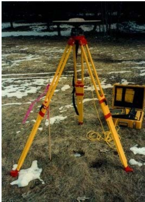
Figura nº 3.- Estació GPS base utilitzada per a realitzar correccions diferencials
