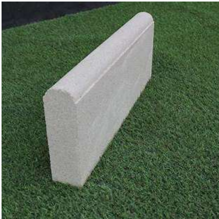
Bordó arrodonit prefabricat (8×20×100cm)
