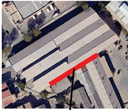
58 ml derribo pared medianera con naves
