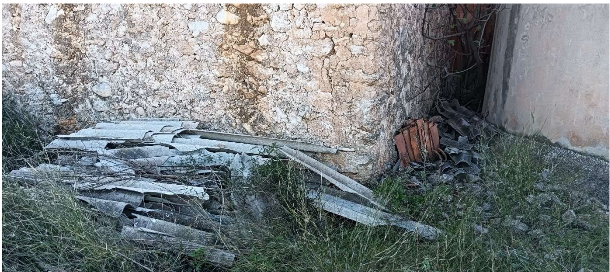
Fig. 14.- Presència d'uralita a les parcel·les objecte d'ampliació.
