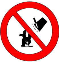
PROHIBIT APAGAR AMB AIGUA
