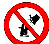
PROHIBIT APAGAR AMB AIGUA
