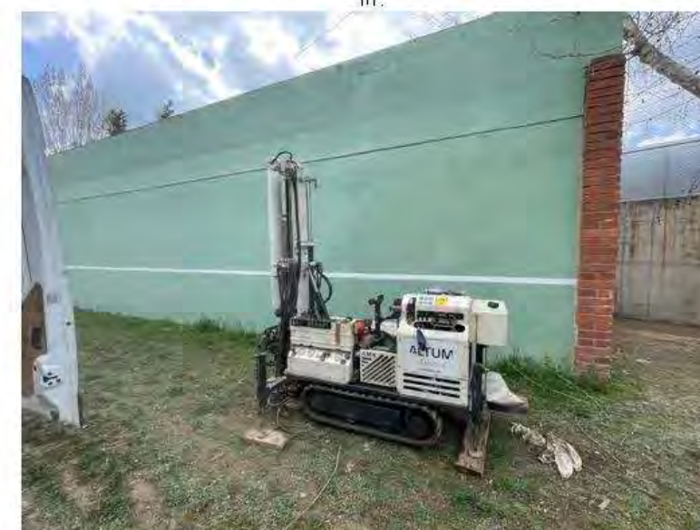
Fotografia de l'emplaçament de l'assaig PD-1, en l'assaig una massa de dimensions normalitzades colpeja el varillatge que es va clavant en el subsòl oferint una resistència a la penetració.
