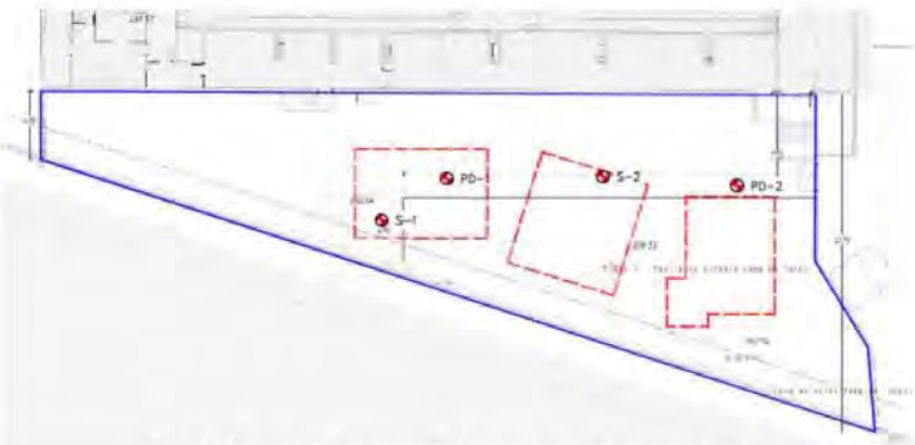
Àrea de l'abast de la campanya de geotècnia en la zona d'estudi.
