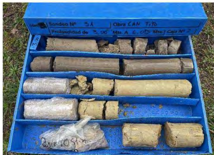
Fotografies de les caixes de recuperació del testimoni del sondeig S-1 de la fondària de 0 m a 3 m i de 3,00 m a 6,00 m.
