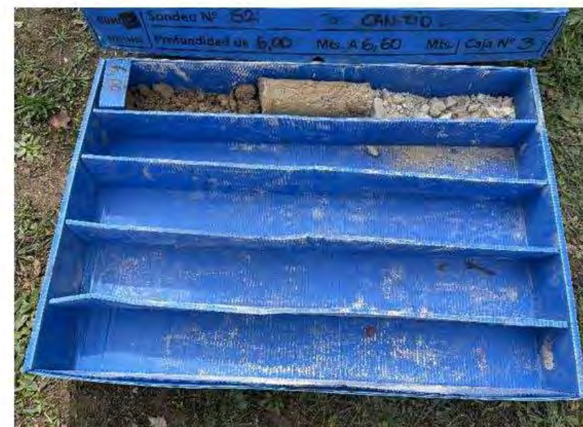
Fotografia de la caixa de recuperació del testimoni del sondeig S-2 de la fondària de 6 m a 6,60 m.
