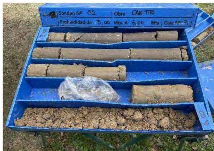
Fotografies de les caixes de recuperació del testimoni del sondeig S-2 de la fondària de 0 m a 3 m i de 3,00 m a 6,00 m.
