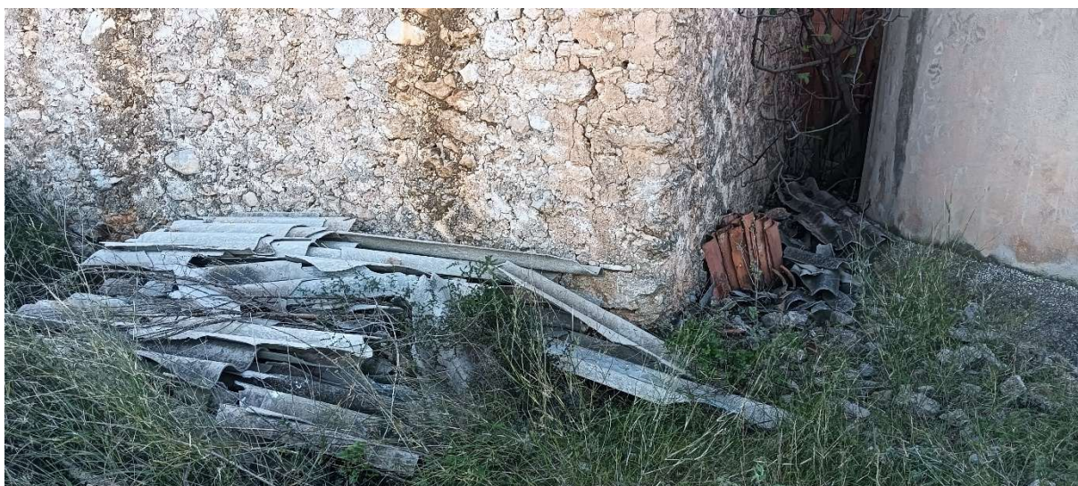
Fig. 14.- Presència d'uralita a les parcel·les objecte d'ampliació.
