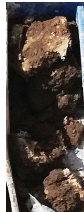
Foto 4. Nivell A. Argiles sorrenques amb graves i runes. Sondeig S-1 de 0,60 a 0,80 metres de fondària.
