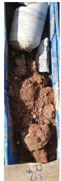
Foto 4. Nivell A. Argiles sorrenques amb graves i runes. Sondeig S-1 de 0,60 a 0,80 metres de fondària.
