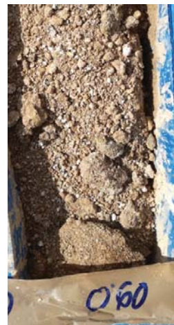
Foto 3. Nivell R. Sauló. Sondeig S-1 de 0,40 a 0,60 metres de fondària.
