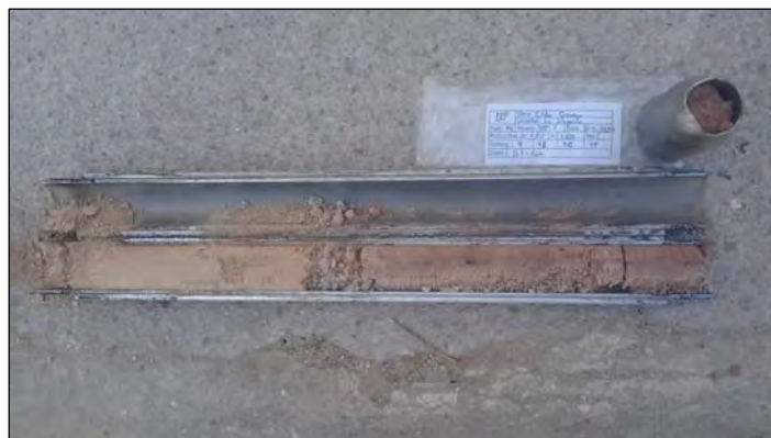
Fotografia 4. Detall dels materials recuperats en l'assaig SPT-1, tram 1A.
