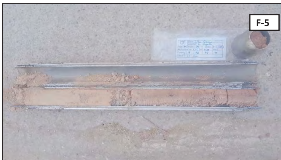
Fotografia 5: Detall dels materials recuperats en l'assaig SPT-1.
