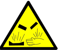
RISC DE CORROSIÓ
