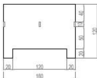
PIEZA 1 ( 2 UNIDADES) ESPESOR DE LA CHAPA: 2 mm.
