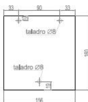
PIEZA 2 ( 1 UNIDAD) ESPESOR DE LA CHAPA: 2 mm.
