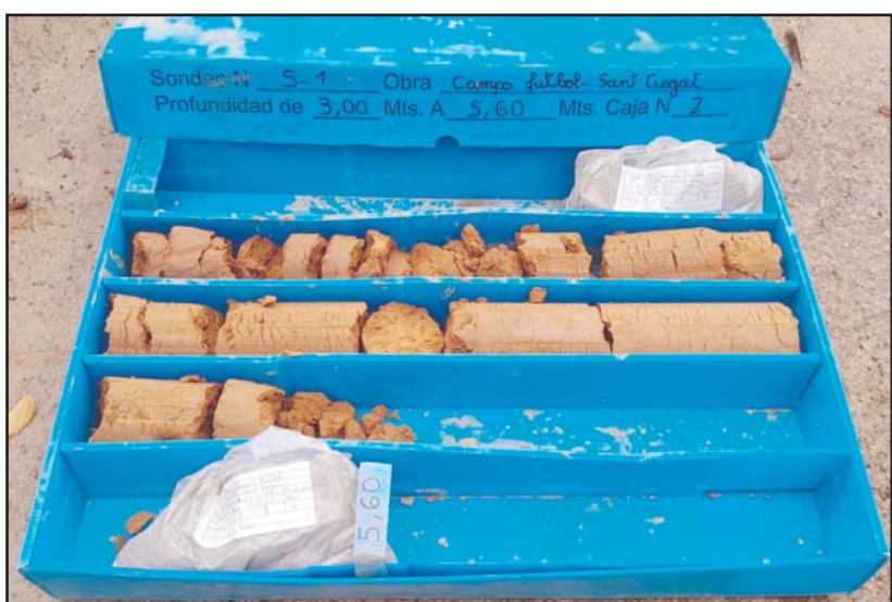
Fotografia 3. Material recuperat en el sondeig S-1 entre les cotes de -3.00 a -5.60 metres de profunditat.
