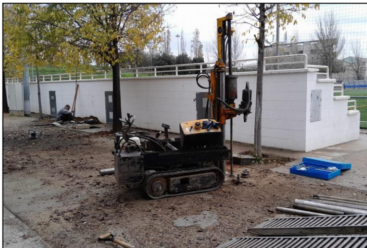
Fotografia 5. Vista de la màquina utilitzada en un dels assaigs de penetració dinàmica realitzats.
