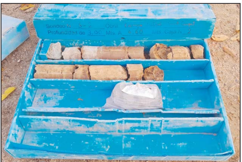
Fotografia 3. Material recuperat en el sondeig S-2 entre les cotes de -3.00 a -4.60 metres de profunditat.
