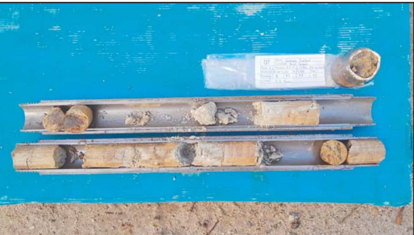
Fotografia 5. Detall del material recuperat en l'assaig SPT-2.
