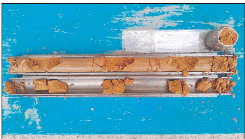
Fotografia 6. Detall del material recuperat en l'assaig SPT-3.
