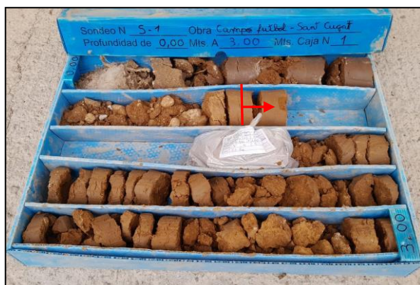
Fotografia 7. Detall dels materials recuperats durant la realització del sondeig S-1.
