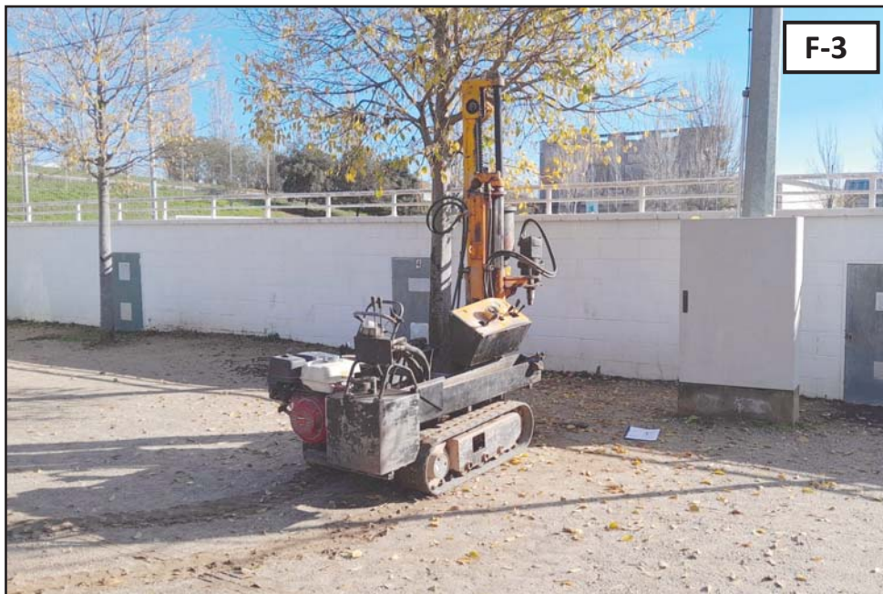
Fotografies 1 i 2: Detall de l'emplaçament de la màquina realitzant l'assaig de penetració dinàmica DPSH, P-3.
