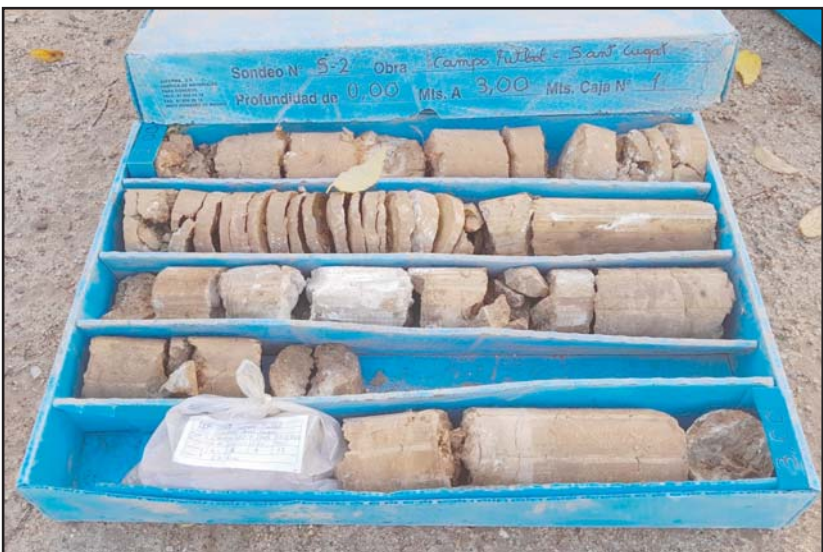
Fotografia 2. Material recuperat en el sondeig S-2 entre les cotes de 0.00 a -3.00 metres de profunditat.
