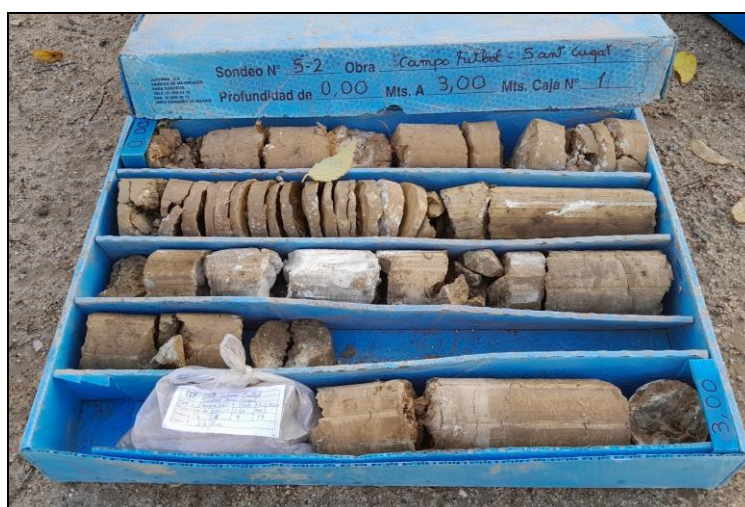
Fotografia 8. Detall dels materials recuperats durant la realització del sondeig S-2.
