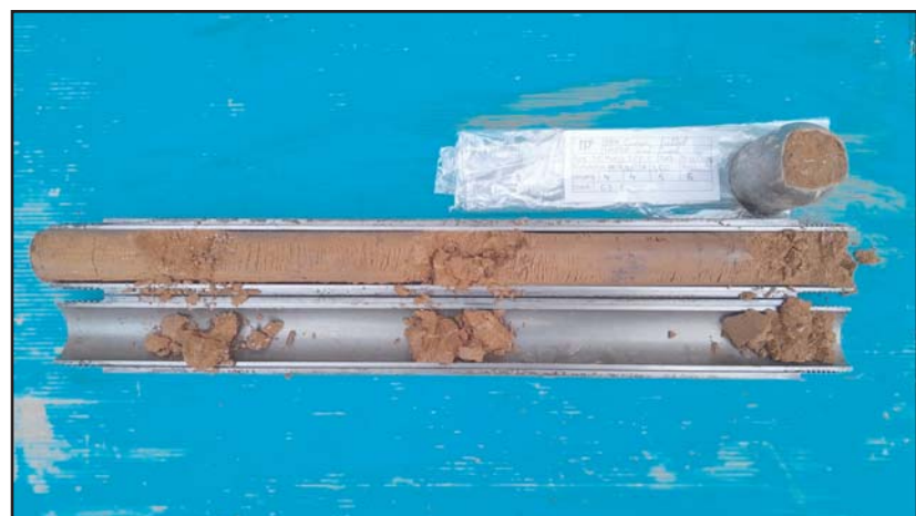
Fotografia 4. Detall del material recuperat en l'assaig SPT-1.
