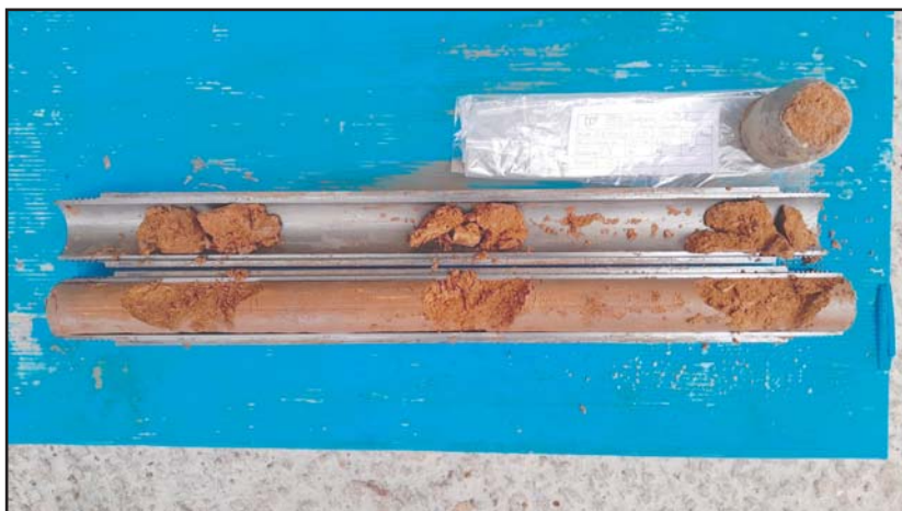
Fotografia 5. Detall del material recuperat en l'assaig SPT-2.
