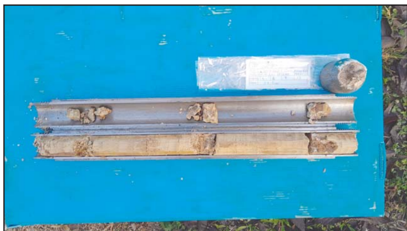
Fotografia 4. Detall del material recuperat en l'assaig SPT-1.
