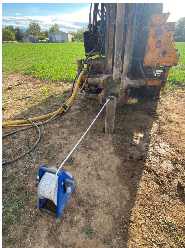
Figura 1. Proves permeabilitat. Assaig de permeabilitat de càrrega variable. Setembre de 2024.
