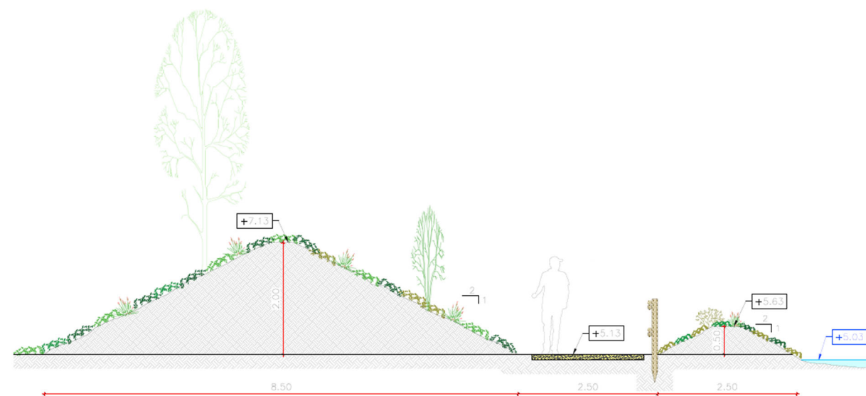
Figura 6. Secció tipus del perímetre de l'Estany en la seva part visitable
