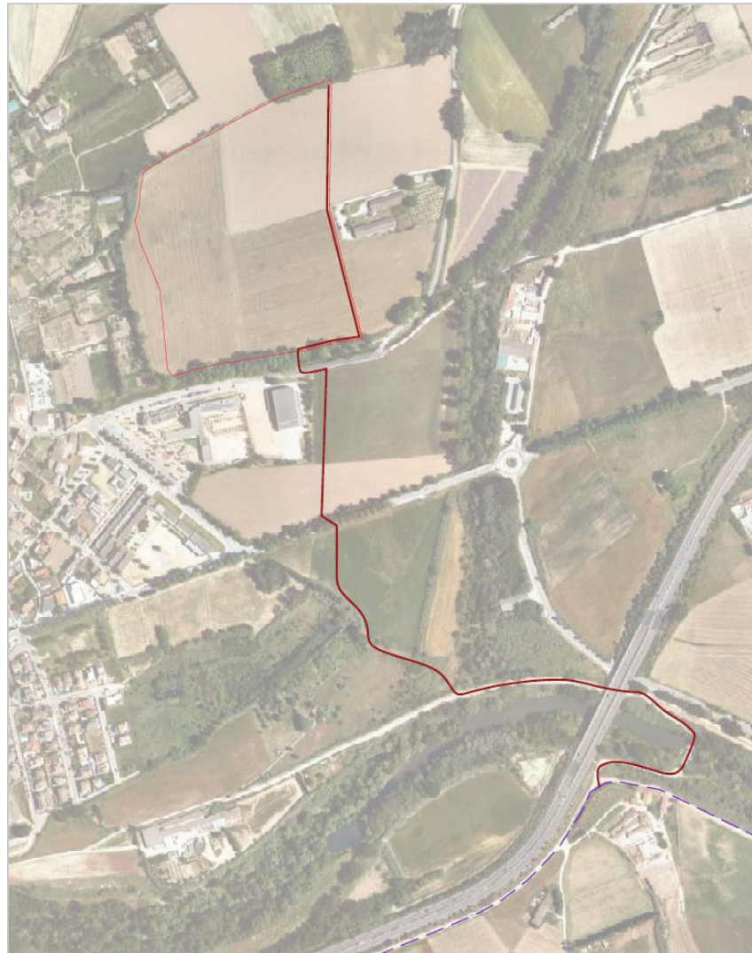
Imatge 2. Traçat de la canonada projectada (línia contínua vermella) per transportar aigua d'una canonada existent procedent de l'EDAR d'Empuriabrava (línia discontinua lila) a l'Estany de la Vila".
