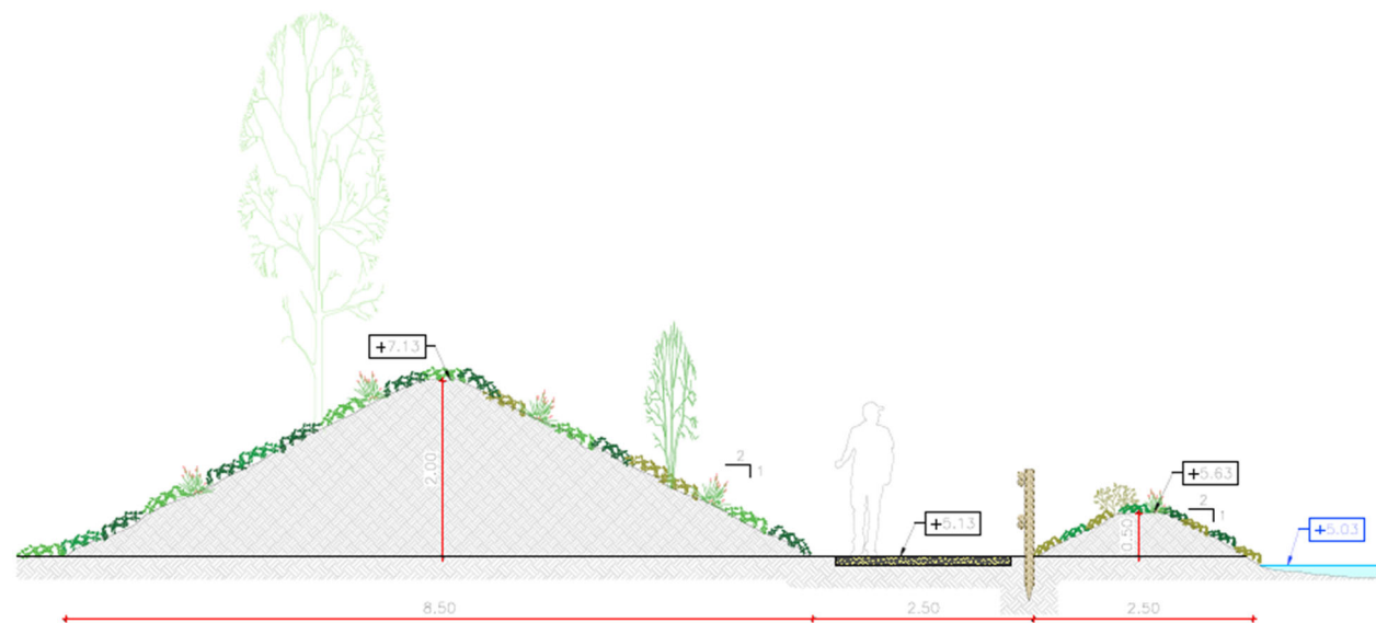
Figura 13. Secció perimetral, mota tipus F. Costat Oest.
