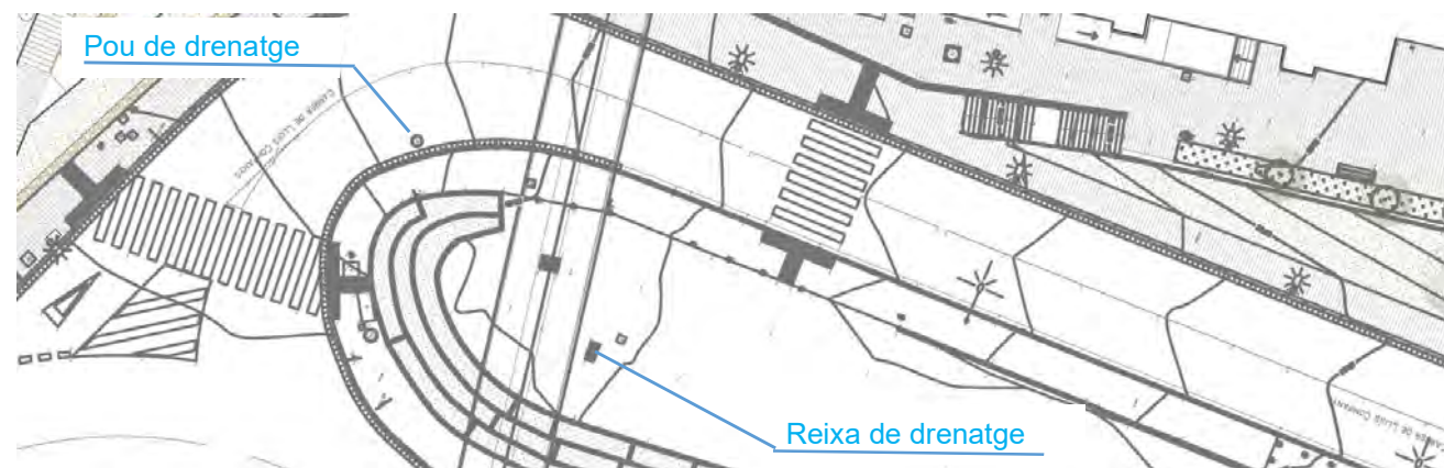
Elements de drenatge àmbit carrer Lluís Companys
