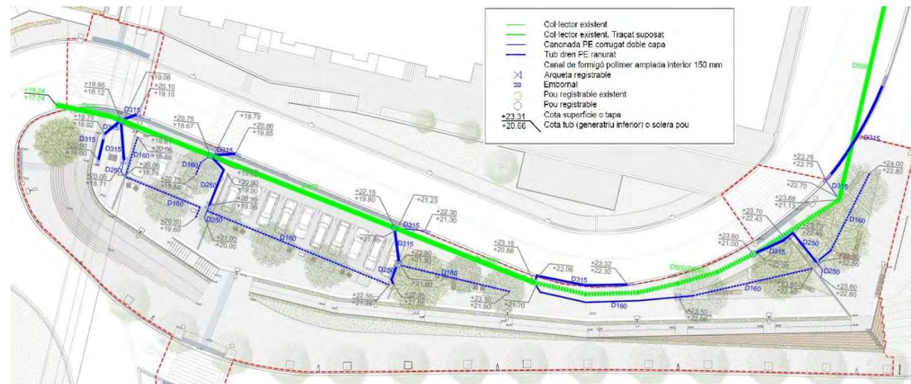
Detall plànol de planta de drenatge
