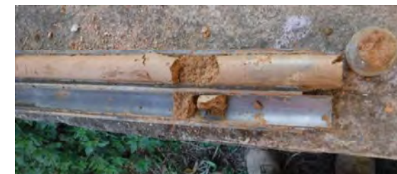
Mostres dels materials de la capa B, als assaigs SPT.
