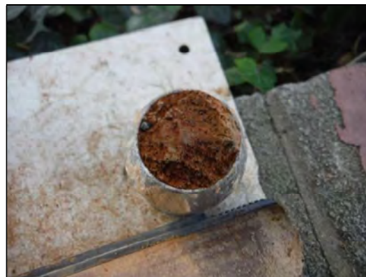
Foto 3: Sondeig S-1, boca SPT a 3,4 metres.
