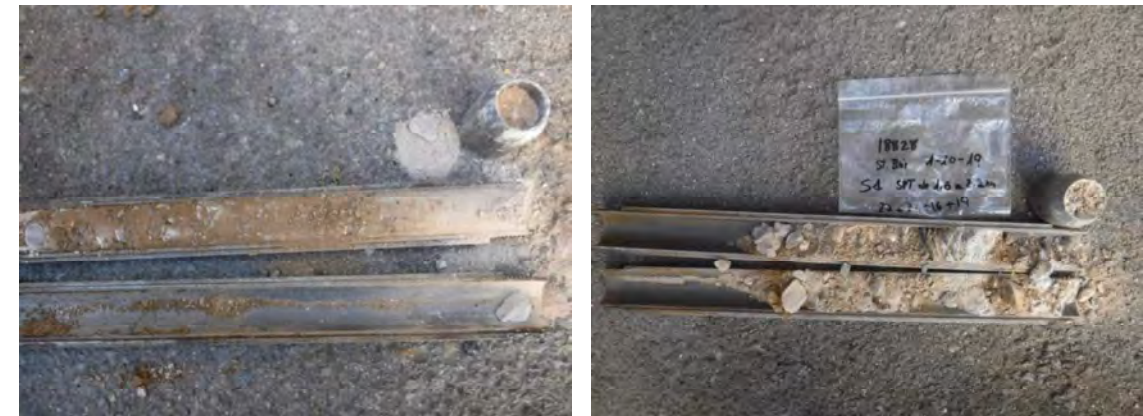
Mostra dels materials de la capa C a l'assaig SPT.
