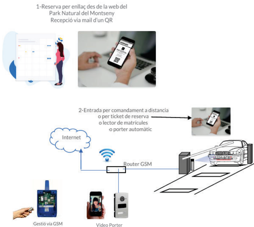
Figura 9. Funcionament del sistema de control d'accessos
