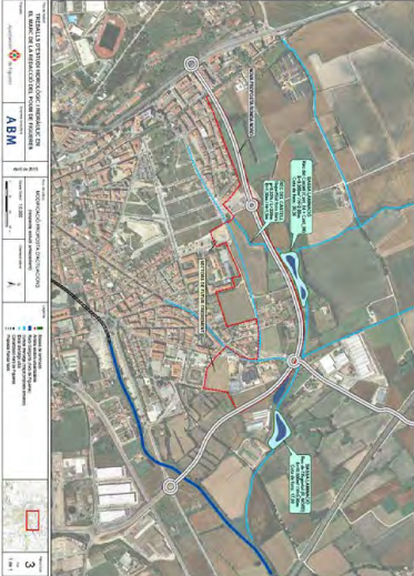
Figura 50. Esquema gràfic de la proposta d'infraestructura hidràulica (Avanç Pla POUJ 2015).
