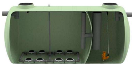
Depuradora d'aigües residuals
