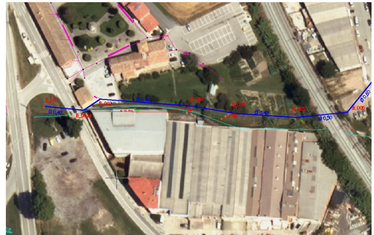
Fig. 8.9: Escameses al primer tram del col·lector en alta. Probable font d'entrada d'aigües blanques.
