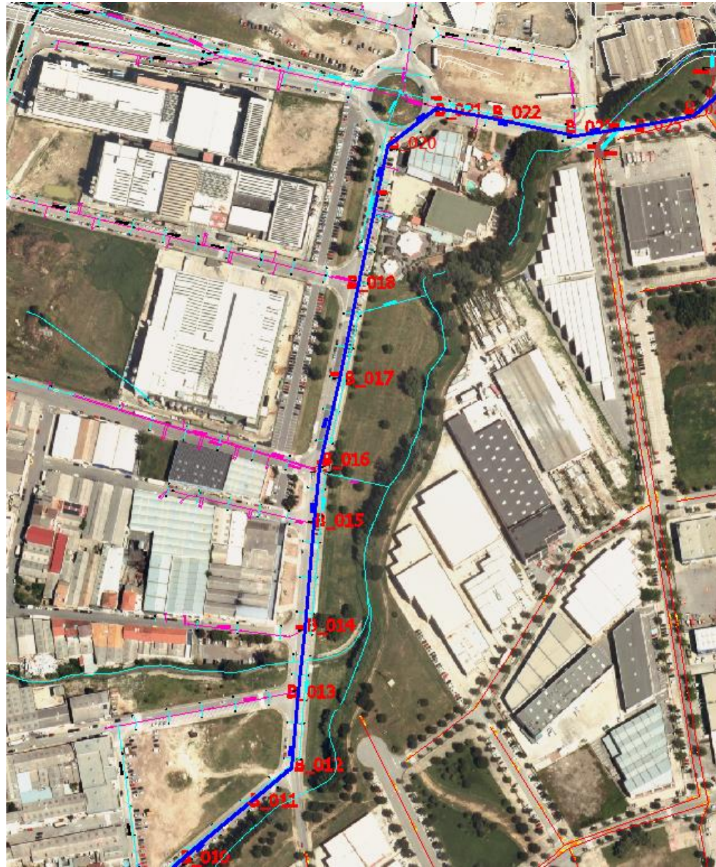
Fig. 8.10: Col·lector pel Pol. Ind. Mas Galí. Escomesa de la xarxa en baixa al col·lector \phi 600 . El col·lector esgota ràpidament la seua capacitat hidràulica.
