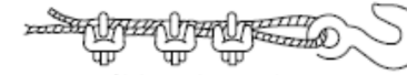
Sistema incorrecte Usar un guardacabs per aumentar la resistència de l'ull i reduir el desgast del cable.
