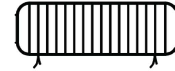
TANCA METÀL·LICA PER A CONTENCIÓ DE PEATONS
