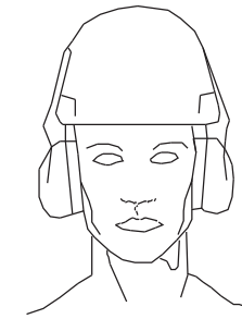
Orelleres acoblades a un casc de protecció per la indústria EN 352-3
