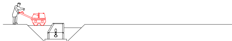
7. Compactació de terres al voltant del pou
