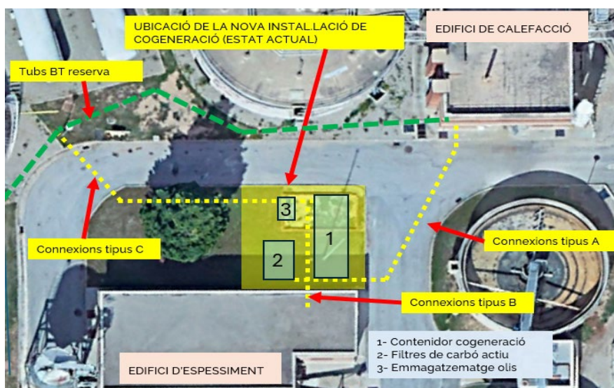
Figura 6: Croquis de les diferents connexions a realitzar entre instal·lacions existents i la nova cogeneració
