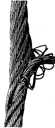
Cliché 10 - Rotura o extrusión del alma de acero generalizada como consecuencia de una deformación en una zona del alma. El cable debe ser retirado inmediatamente.
