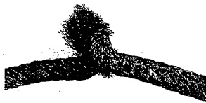
Cliché 15 - Capa muy gruesa. Observar la expansión del alma textil. El cable debe ser retirado inmediatamente.
