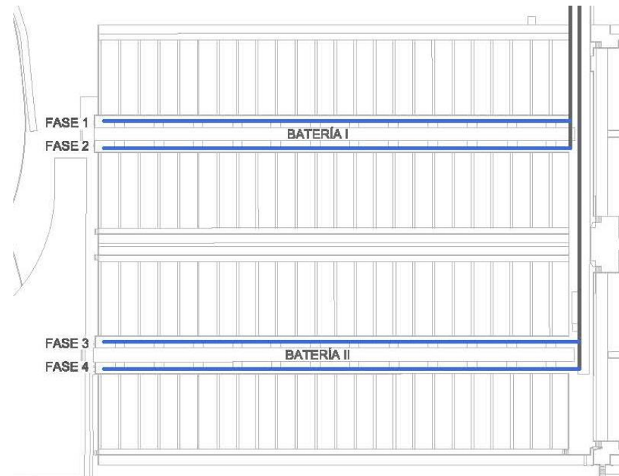
Esquema explicatiu del recorregut de les canonades d'aire de rentat
