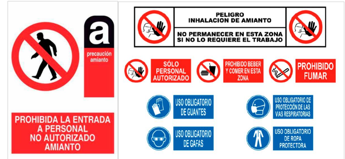
Senyalització tipus necessària a implantar als accessos de l'obra.
