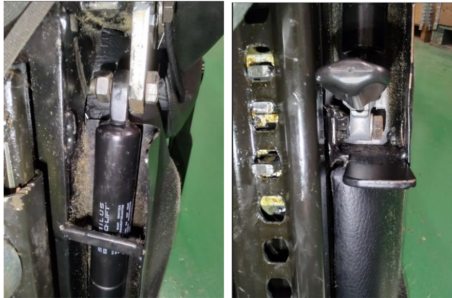
Fig. 2.- Caragols de subjecció de l'amortidor del suport
