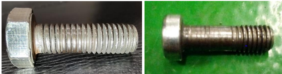
Fig.3.- Caragols de l'amortidor del suport deformats
