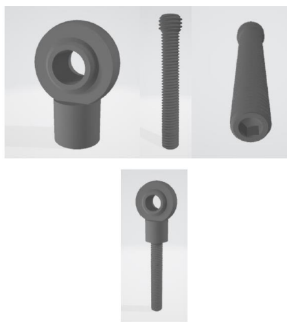
Fig.26 Ròtula Unibal retallada juntament amb l'espàrrec especial
