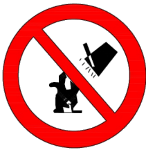
PROHIBIT APAGAR AMB AIGUA
