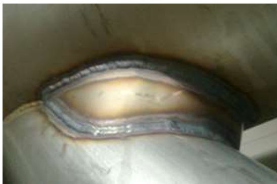
Figura 2. Diverses reparacions efectuades i reforços soldats al col·lector
