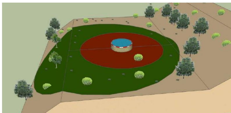
Figura 1. Exemple de forma de les AS: més amples de la banda per on el foc pujaria pel pendent ascendent.
