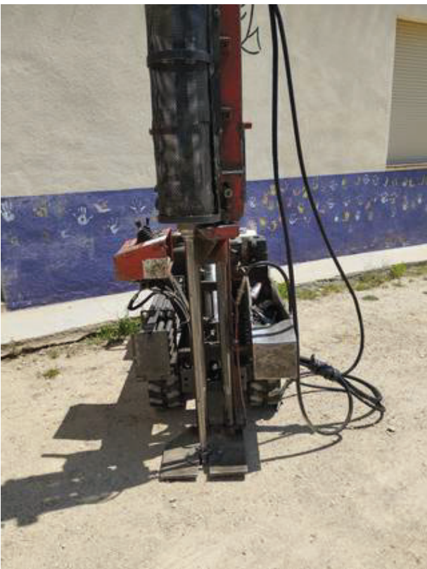
Vistes dels quatre sondeigs realitzats a la parcel·la objecte d'estudi, P-1 i P-3 del tipus DPSH i, S-2 i S-4 del tipus Rotació helicoidal.
