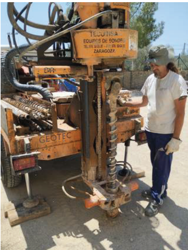
Vistes dels quatre sondeigs realitzats a la parcel·la objecte d'estudi, P-1 i P-3 del tipus DPSH i, S-2 i S-4 del tipus Rotació helicoidal.
