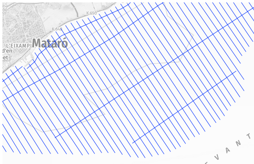
Figura 7. Exemple de distribució de perfils sísmics com a font de dades per SDB
