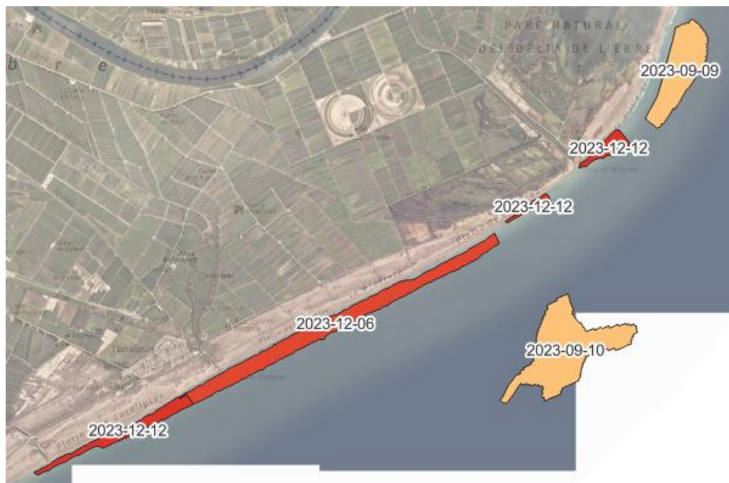
Figura 9. Exemple de capa amb els àmbits de les imatges satèl·lit emprades per derivar productes batimètrics
