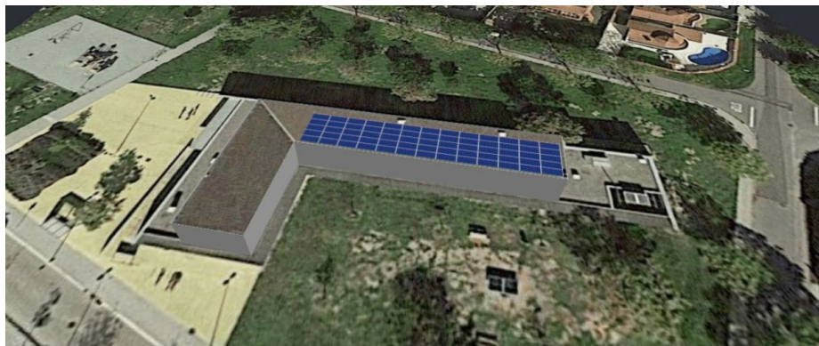
Figura 2. Distribució panells sobre teulada Centre empen Empuriabrava
