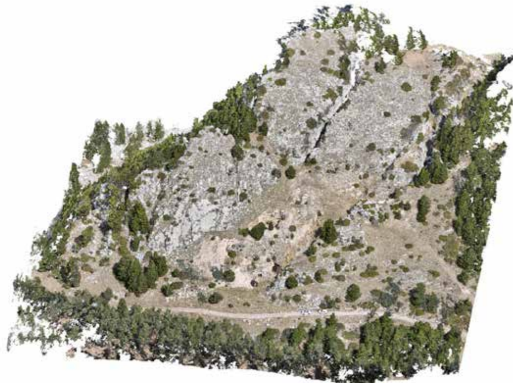
Figura 5. Model 3D de la zona d'estudi. Una vegada realitzat el vol s'integren totes les imatges per a generar un núvol de punts georeferenciats. Aquest model permet disposar d'una acurada triangulació del model 3D, i definir pendents, longitud, etc.
