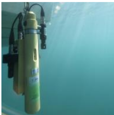
Figura 5.- Sonda multiparamètrica STD/CTD model SD204 per al caracteritzat de l'estructura vertical de la columna d'aigua.
