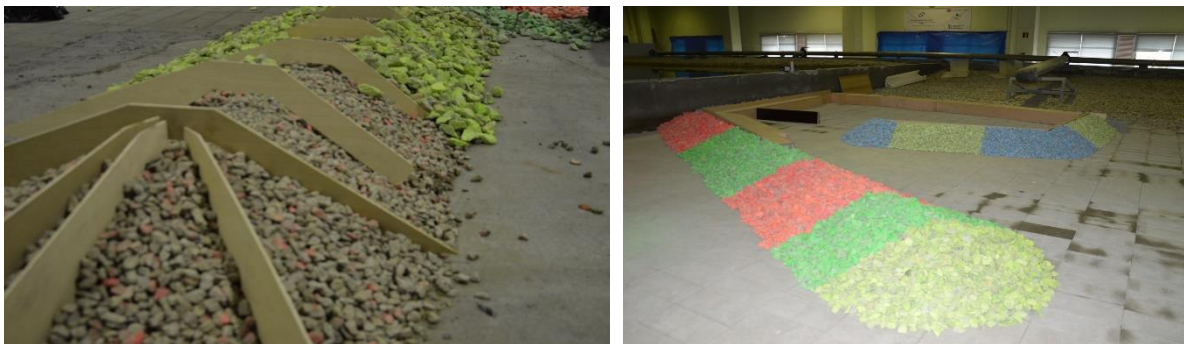
Figura 15 Colocación de la primera capa del manto y resultado final del dique y contradique de la situación actual del puerto de Les Cases d'Alcanar
