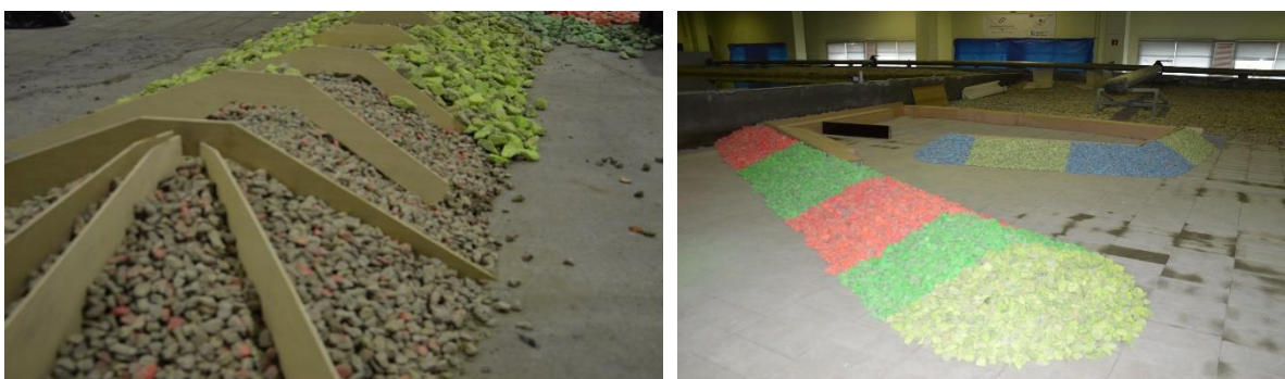
Figura 36 Col·locació de la primera capa del mantell i resultat final del dic i contradic de la situació actual del port de Les Cases d'Alcanar
