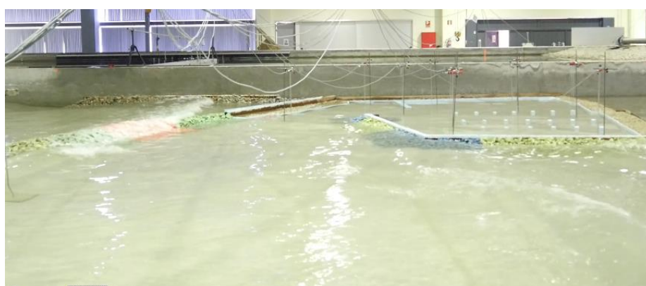
Figura 32 Ensayo de agitación de la situación actual y Tr=200 años en el momento de máximo periodo
