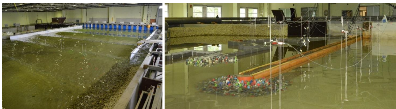
Figura 5 Dársena de Oleaje en el CITEEC. Dársena con Sistema de generación Multidireccional y modelo (33x16.5x1.2m)
