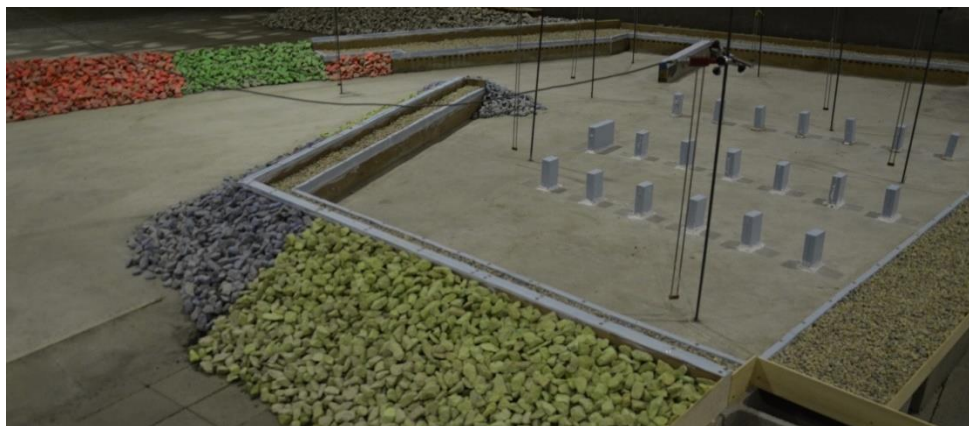
Figura 31 Sondes d'onatge col·locades en el model per a la mesura de l'agitació interior
