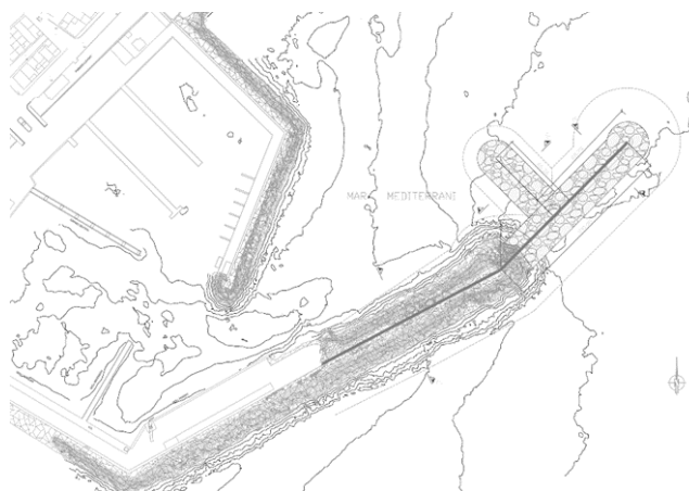
Figura 20 Alternativa 2 propuesta para la solución de la agitación del puerto de Les Cases d'Alcanar
