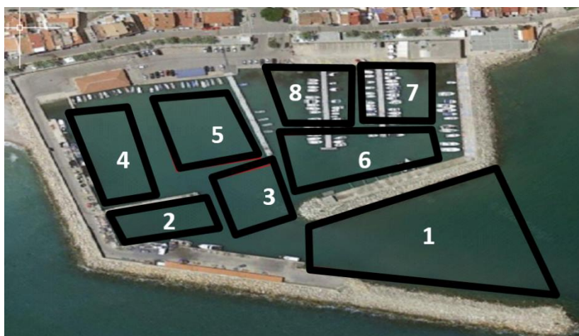
Figura 24 Zonas de estudio de la agitación en los ensayos de agitación realizados en la dársena de Puertos y Costas del CITEEC
