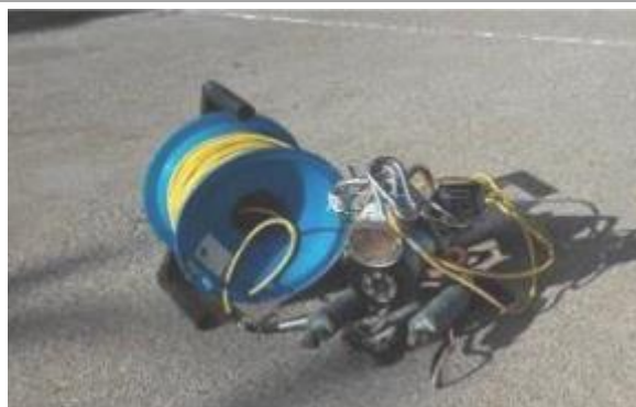
Figura 9.- Detall de la càmera de vídeo muntada sobre el patí metàl·lic hidrodinàmic.
