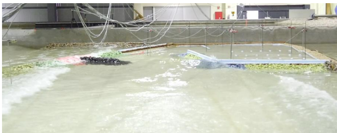
Figura 40 Ensayo de agitación de la alternativa 1 y el Tr=200 años en el momento de máximo periodo
