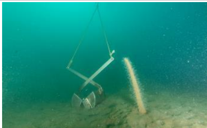
Figura 8.- Draga Van Veen utilitzada per a la recollida de mostres de sediments.
