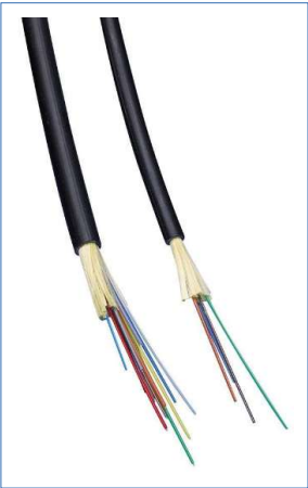
Il·lustració 76: Cable de fibra òptica multimode OM4 50/125 amb cobertura LSZH amb CPR Cca
