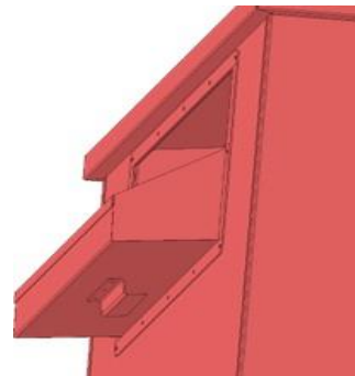
DETALLE BOCA DE USUARIO ANTIATRAPAMIENTO Y ANTIRROBO CON VOLUMEN DE 50 LITROS.
