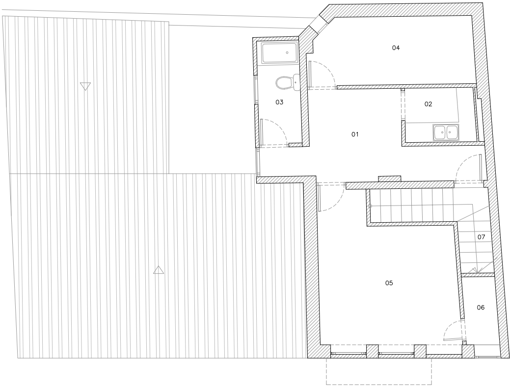
PLANTA PRIMERA (Superficie Construida 54m2)
