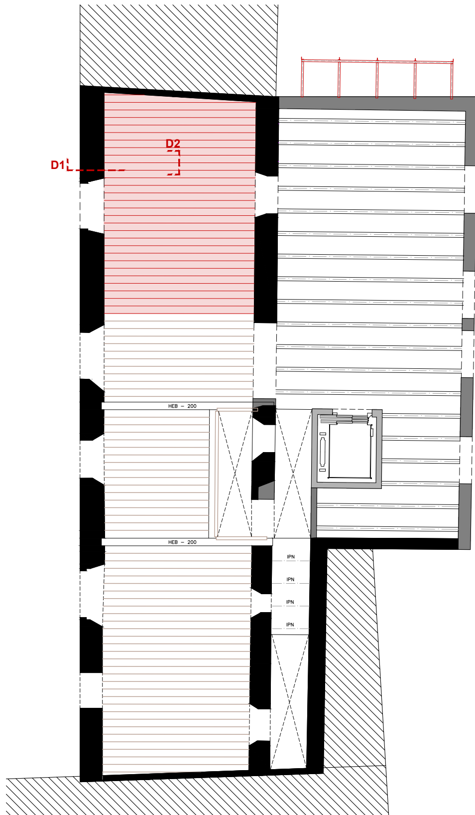
ESTRUCTURA SOSTRE PLANTA BAIXA. ESPECEJAMENT BIGUES GIRADES 20X20CM E: 1/100
