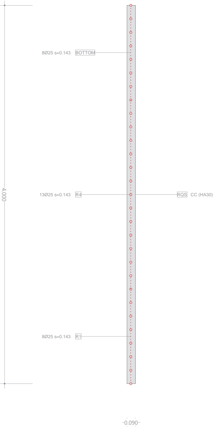
Sección transversal LOSA90X400 (HA30;B500S): Contorno, Armaduras
