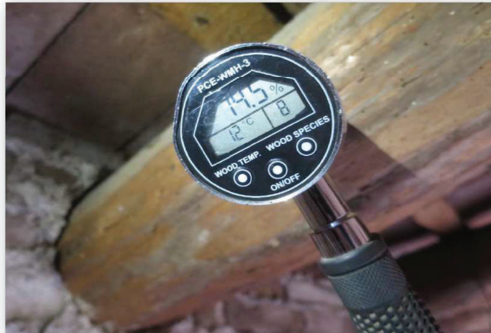
Sostre de la planta 1 (P1). Element P1C7. Imatge 375 Mesurament de la humitat
