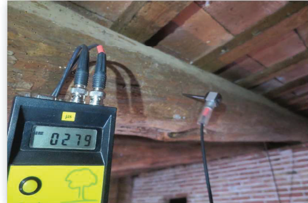
Sostre de la planta 1 (P1). Element P1C5. Imatge 386 Assaig amb ultrasons per estimar el mòdul d'elasticitat
