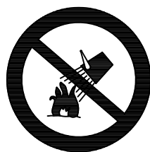
PROHIBIT APAGAR AMB AIGUA
