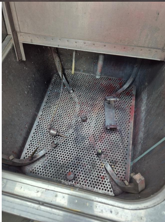
Detall cubeta interior de neteja de pistoles i equips de pintura
