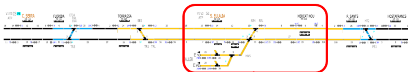
Figura 9 Esquema actual de vies del tram afectat per les obres.
