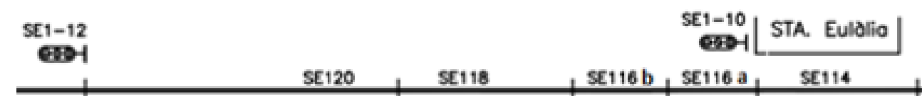
Figura 19 Esquema futura configuració amb desdoblament de CCV SE116.
