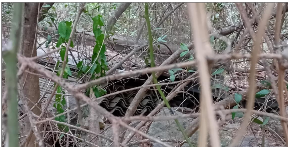
Imatge 2. Plaques de fibrociment dins l'àmbit d'estudi. Data: 09/07/2025
