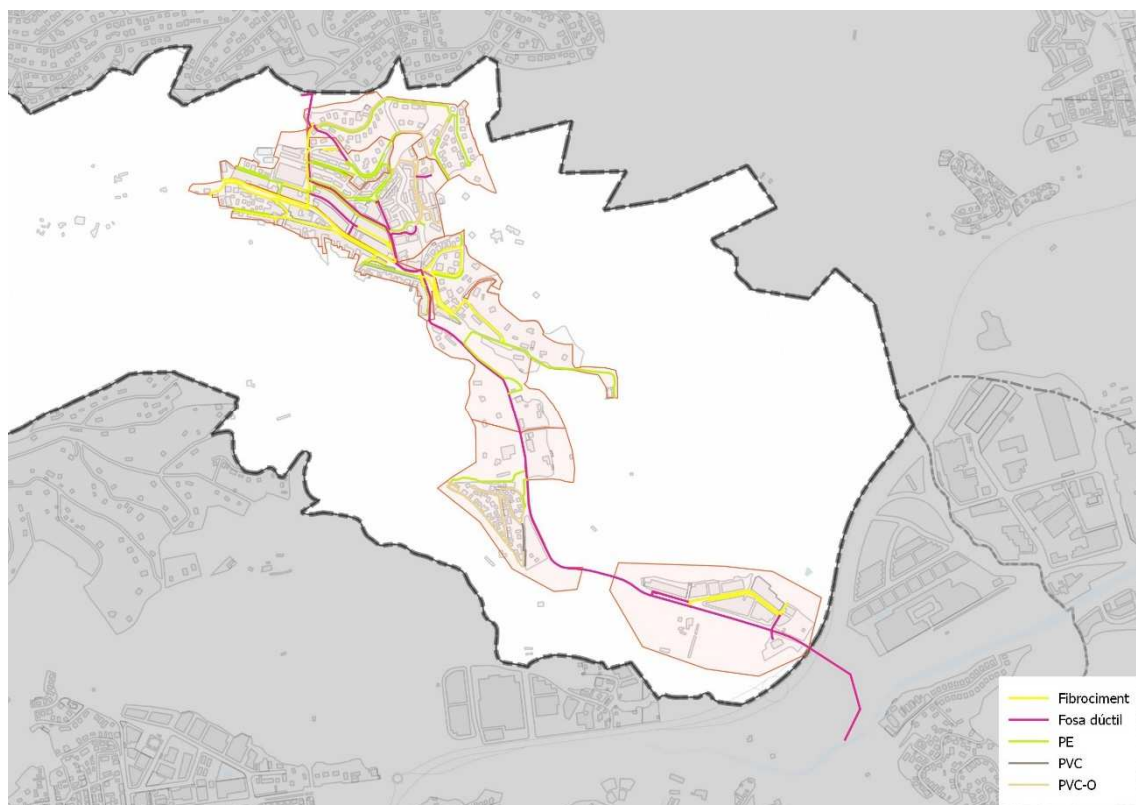
Imatge 26: Materials a les canonades de distribució i transport
